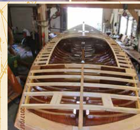
Der Decksunterbau und das fast fertige Deck
