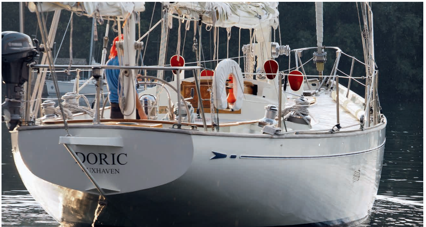
Die Schot des weit achtern stehenden Besans wird über einen Heckausleger gefahren. Auffällig sind auch die vielen großen Lüfter sowie das breite Laufdeck und der nach oben einschnürende Spiegel
